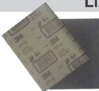
O Sistema de folhas Lixa D'água 231Q e 211Q são indicadas para operações manuais a úmido na reparação automotiva. Realizam operações de nivelamento, desbastes e acabamentos de massa poliéster, plástica e/ou rápida, primers, tintas e vernizes.
