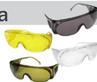
Óculos de Segurança Panda constituídos de armação e visor em uma única peça de policarbonato. Além disso, as hastes, do tipo espátula, são confeccionadas do mesmo material da armação, possuem 6 fendas para ventilação e são fixas à armação através de pinos plásticos.
