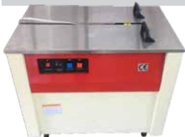
Máquina de Arqueação veloz, tensiona, sela e corta a fita automaticamente. Exclusivo fecho duplo de termo solda profunda. Máquina para arquear, compacta, leve e equipada com rodas facilitando o transporte. Desliga automaticamente se não for usada. Extremamente funcional confiável e de fácil operação.
